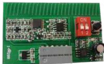
Funcionamiento con emisores a Código Cambiante Roller Code
