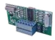
Regulación y programación mediante potenciómetro y dip switch
